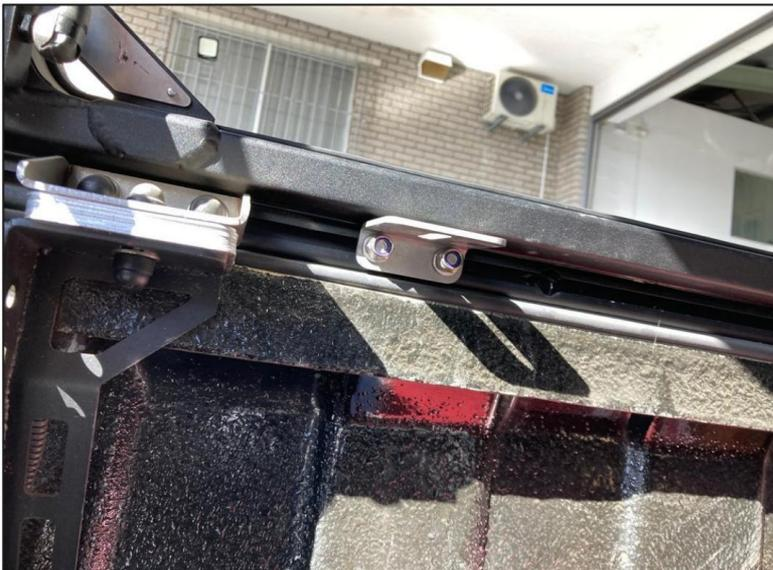
Ne serrez les écrous qu'à la main, car il pourrait s'avérer nécessaire de les déplacer ultérieurement.
