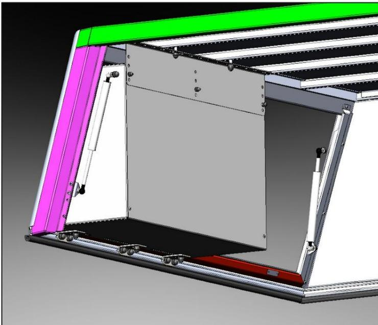
Installez les 3 supports inférieurs sur le cadre à fente pour écrou de canopée à l'aide des boulons M8x20, des écrous Nylock et des rondelles de fixation fournis. Faites glisser les boulons M8x20 dans le cadre à fente pour écrous de l'auvent (2 par support de montage).
