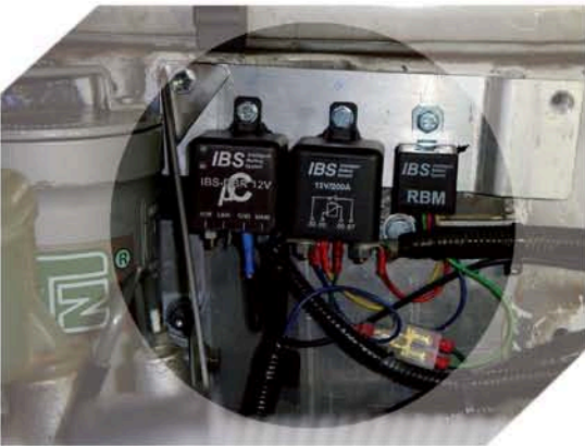
Exemple d'installation du IBS-DBR dans le compartiment moteur
