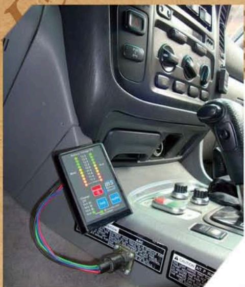
Monitor d'un Dual Batterie Système monté dans un véhicule
