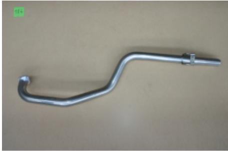
**ECHAPPEMENT INOX : TUBE ARRIERE (MODELE 24s) POUR TOYOTA LAND CRUISER HDJ80 DE 1996-1998 4.2L TD**
