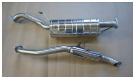
**ECHAPPEMENT INOX : INTERMEDIAIRE AVEC SILENCIEUX ET TUBE ARRIERE AVEC RESONATEUR POUR TOYOTA LAND CRUISER HJ61 DE 1985-1990 4.0L TD 136HP**
