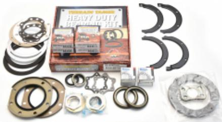
**KIT PIVOT ET ROULEMENTS DE ROUES
