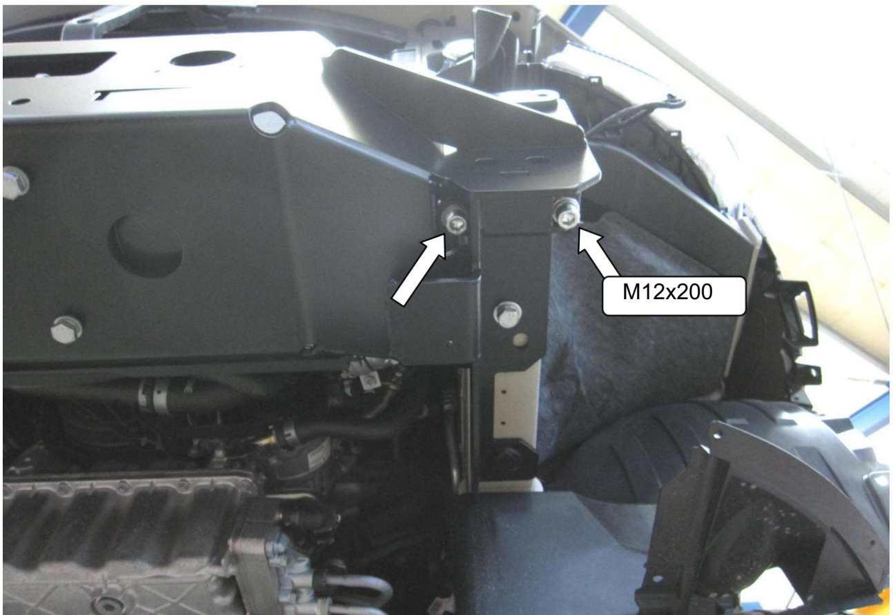
13 Installez d'abord la vis intérieure ! / Montez d'abord la vis intérieure ! Pareil du côté droit ! / Le même à droite !
