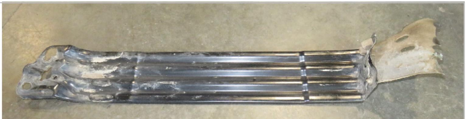
Positionner la DVSP368B au bord du plis de la pièce d'origine. Découper la protection d'origine, pointer et percer les 6 trous Ø9.
