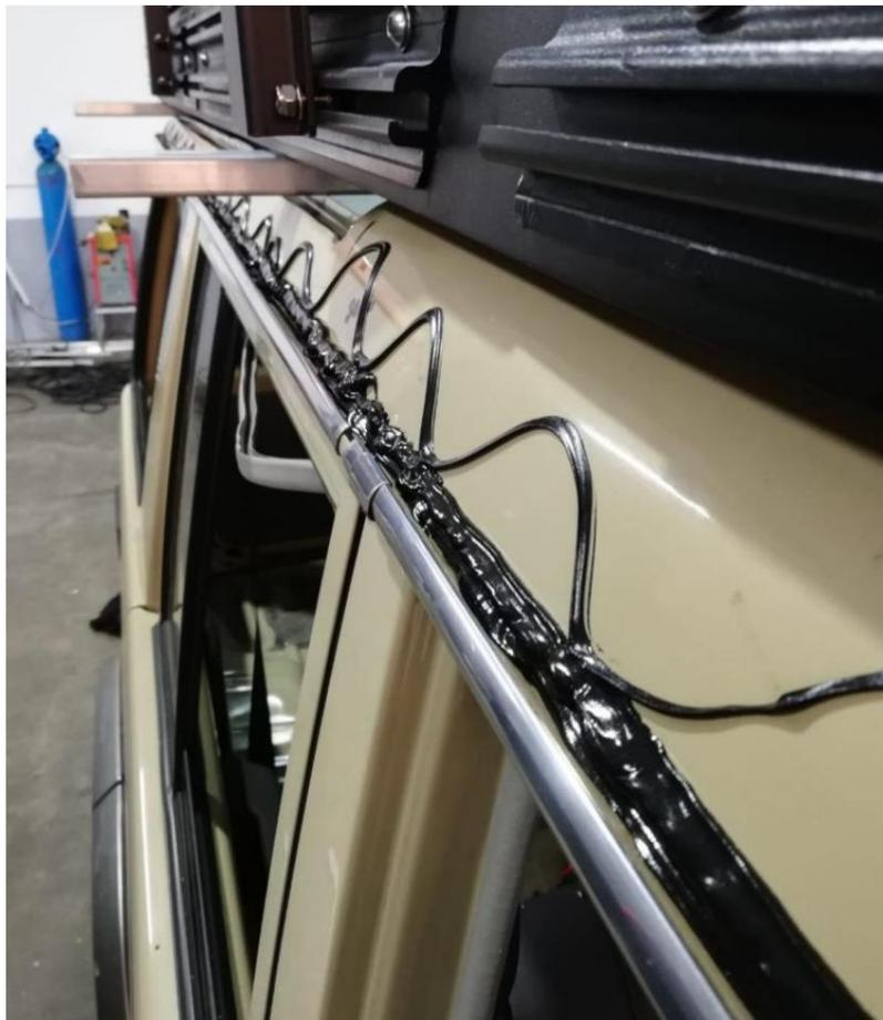
Appliquez Sika flex le long de l'intérieur de la face avant de la conversion du toit Thor ainsi que sur la carrosserie du véhicule au-dessus du pare-brise.
