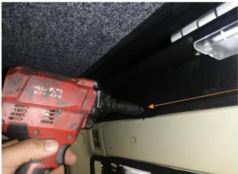
Utilisez un pistolet à rivets pop pour fixer les rivets pop en place.
