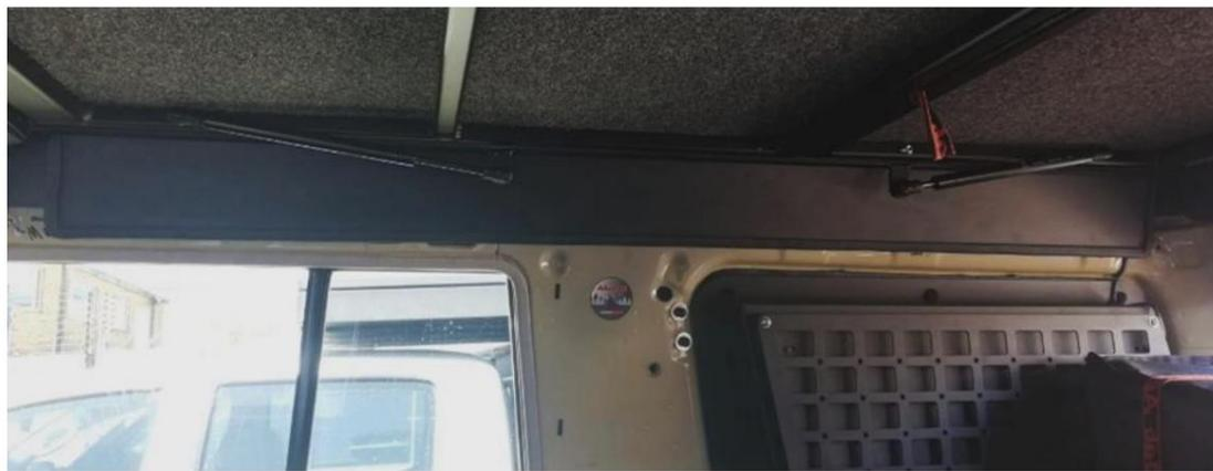
Le panneau arrière doit être mis en place grossièrement et à l'aide d'un marqueur, les trous sur le corps qui correspondent à la plaque de recouvrement doivent être marqués et percés à 5 mm de diamètre.
