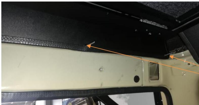
Une fois les trous réalisés percé plus grand, vous pouvez maintenant procéder à la mise en place du panneau arrière et insérer les rivets pop
