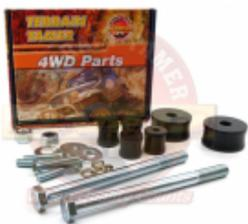
Lorsqu'un véhicule est équipé d'une suspension rehaussée, l'angle des joints homocinétiques et des cardans est modifié, provoquant une usure prématurée de ces derniers. Ce phénomène est d'autant plus accentué par l'utilisation de grosses roues. Le kit de rabaisssement de pont avant Terrain Tamer corrige la géométrie des joints homocinétiques et cardans en rabaissant le différentiel d'environ 25mm, et garantissant ainsi un réalignement des cardans. Compatible pour : Hilux KUN25-26 Hilux...
